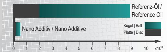
4-Ball Verschleißtest | 4-ball wear test
